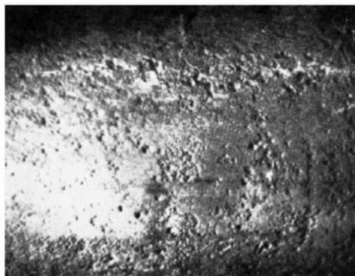
Figura 10 – Corrosão Generalizada com Alvéolos na Parede de Cilindro Pequeno
