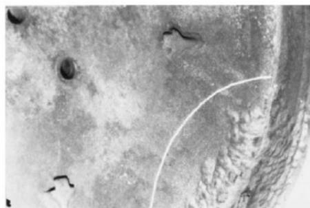
Figura 11 – Corrosão na Borda de Extremidade do Cilindro Grande
